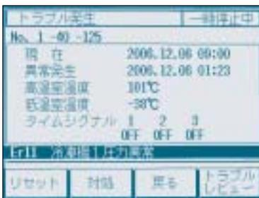
トラブルの種類、発生時間を表示します。
