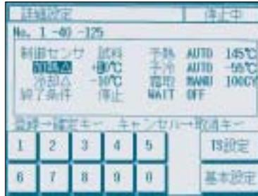
試料温度を基準にして温度制御を行います。
